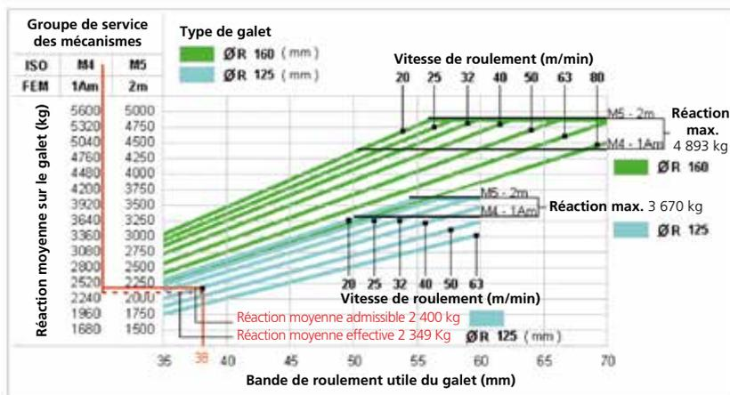
**Exemple de contrôle de l'aptitude du galet Ø 125**
